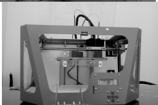
شکل ۷: دستگاه چاپگر سه بعدی رسوب مذاب دانشگاه صنعتی شریف
