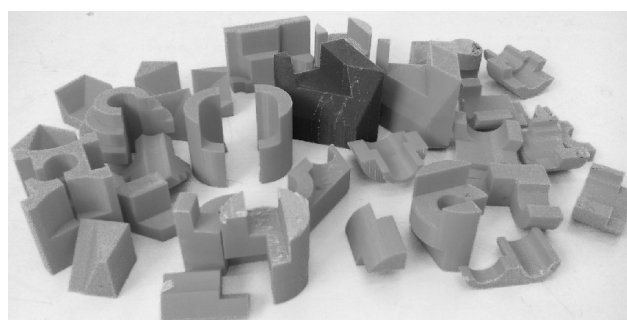
شکل ۱۱: مدل‌های فیزیکی تمرین‌های درس نقشه‌کشی صنعتی که با چاپگر سه‌بعدی درست شده‌اند
