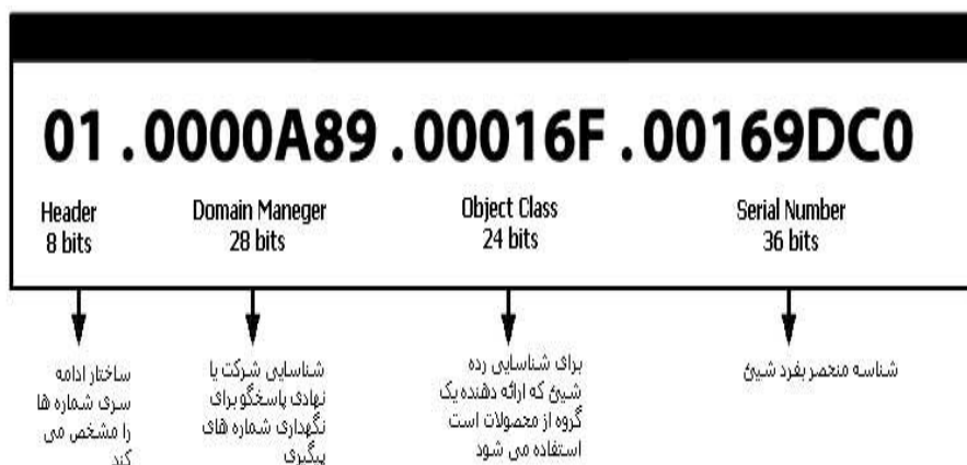
شکل ۴: نمونه‌ای از یک کد الکترونیکی ۹۶ بیتی
