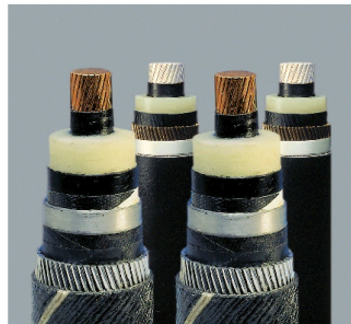
شکل ۵: کابل‌های دریایی و زمینی برای سیستم VSC-HVDC
