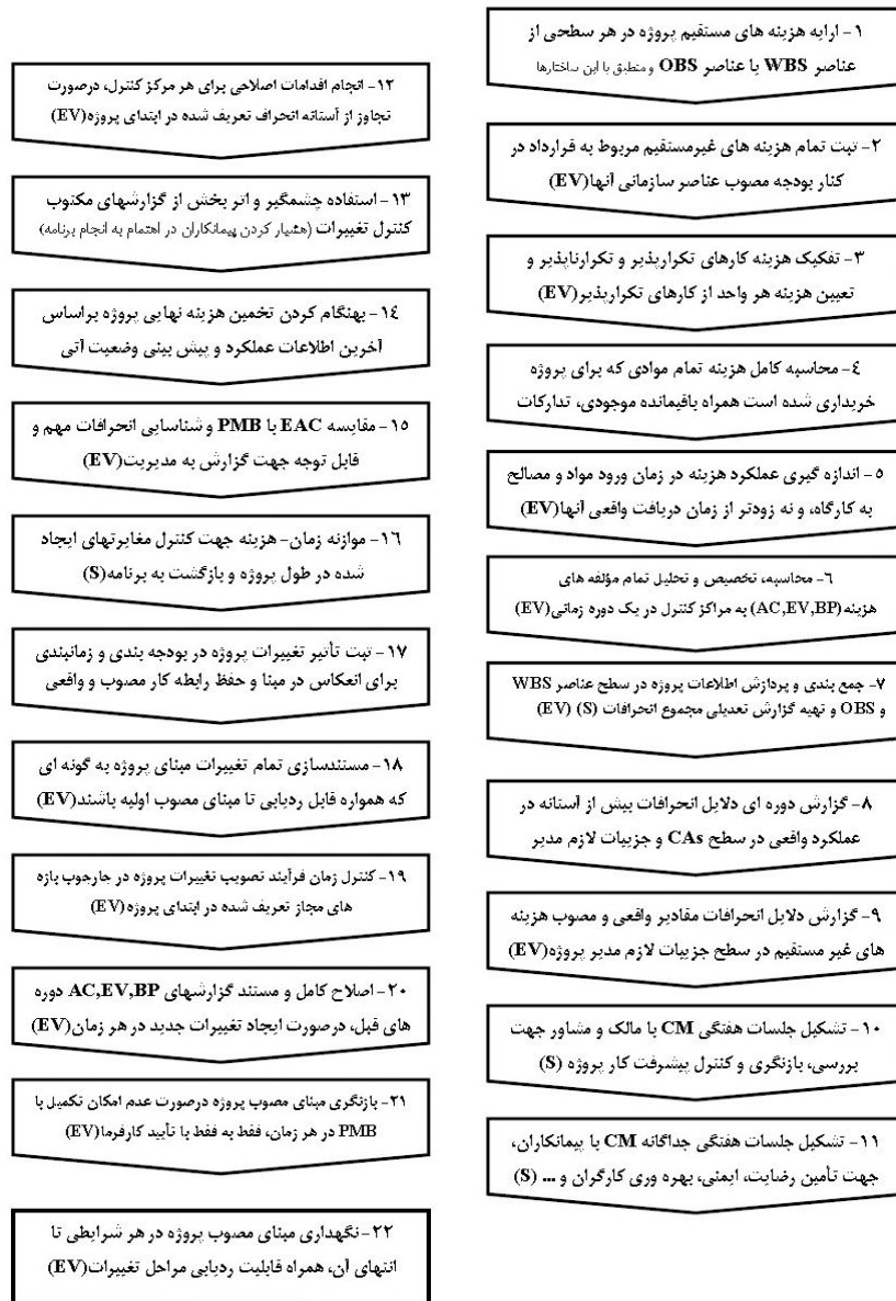
شکل ۱۲: فرایند کنترل پروژه نهایی، طراحی شده بر اساس معیارهای بررسی شده
