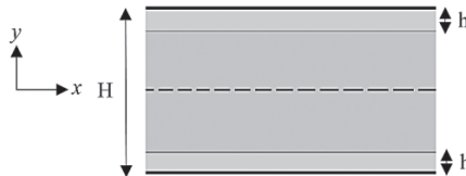
شکل ۱: نمودار شماتیک جریان موازی درون کانال به ضخامت H. فاز ترکنده به ضخامت h بر روی دیواره کانال و فاز دیگر در میانه کانال جریان دارد. مبدأ محور مختصات در مرکز کانال فرض می‌شود.
