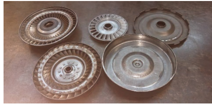
مبدل گشتاور (تورک‌کانورتور) برش خورده
