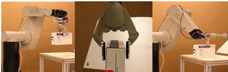
شکل ۵: روبات طراحی شده با ۶ درجه آزادی
